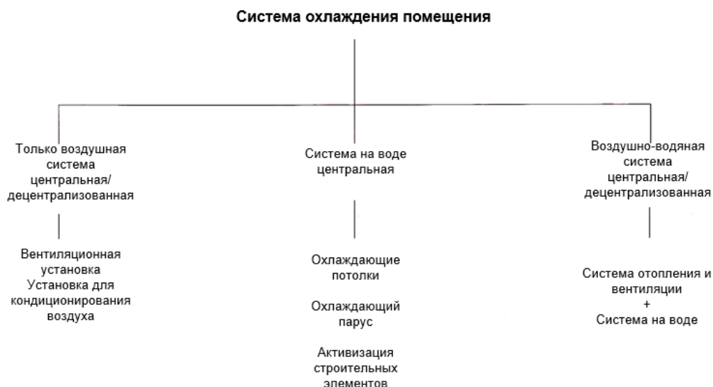
Рис. 8: Обзор систем охлаждения помещений (по Хайнер 2010, стр.62)
