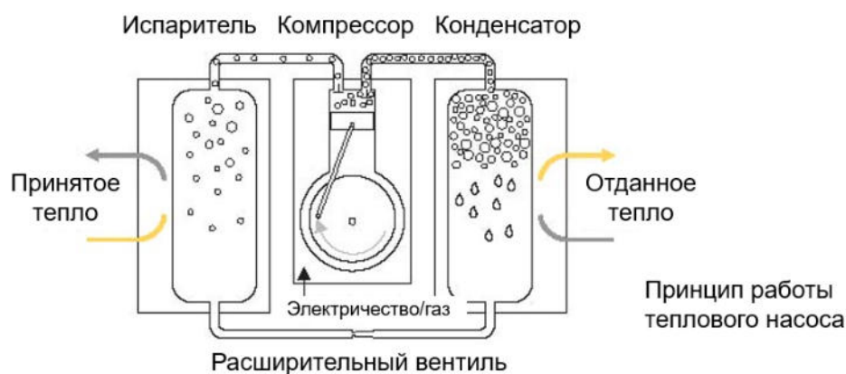
Рис. 10: Принцип работы теплового насоса 9
