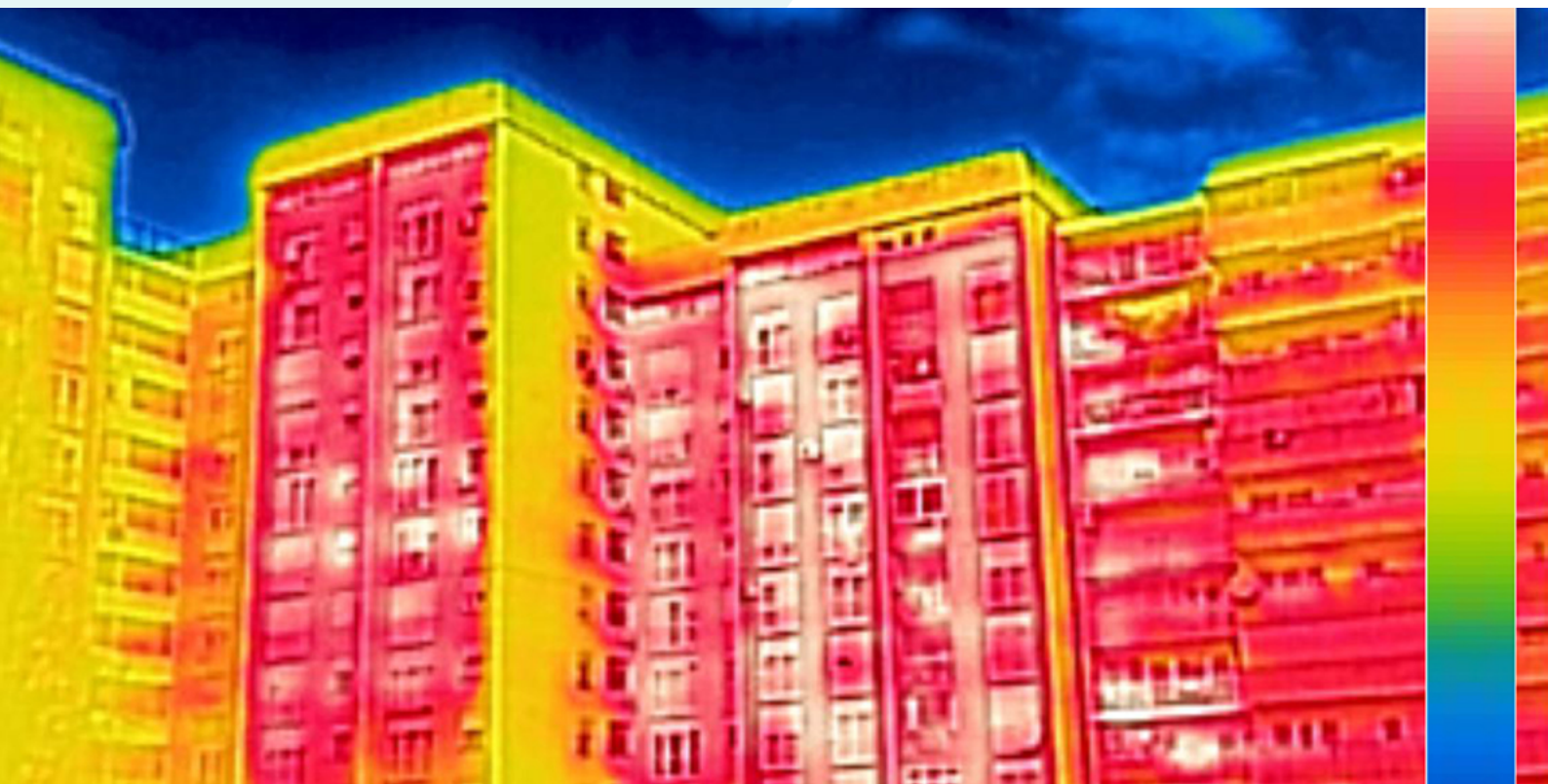
Тепловизионный снимок многоквартирного жилого дома после модернизации
