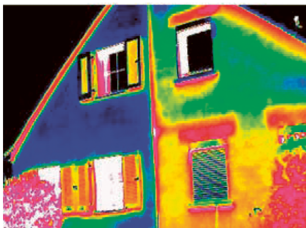
Рисунок 56: Двухквартирный дом, левая часть дома модернизирована с помощью многослойной теплоизоляционной системы – низкие теплопотери (синий цвет)
